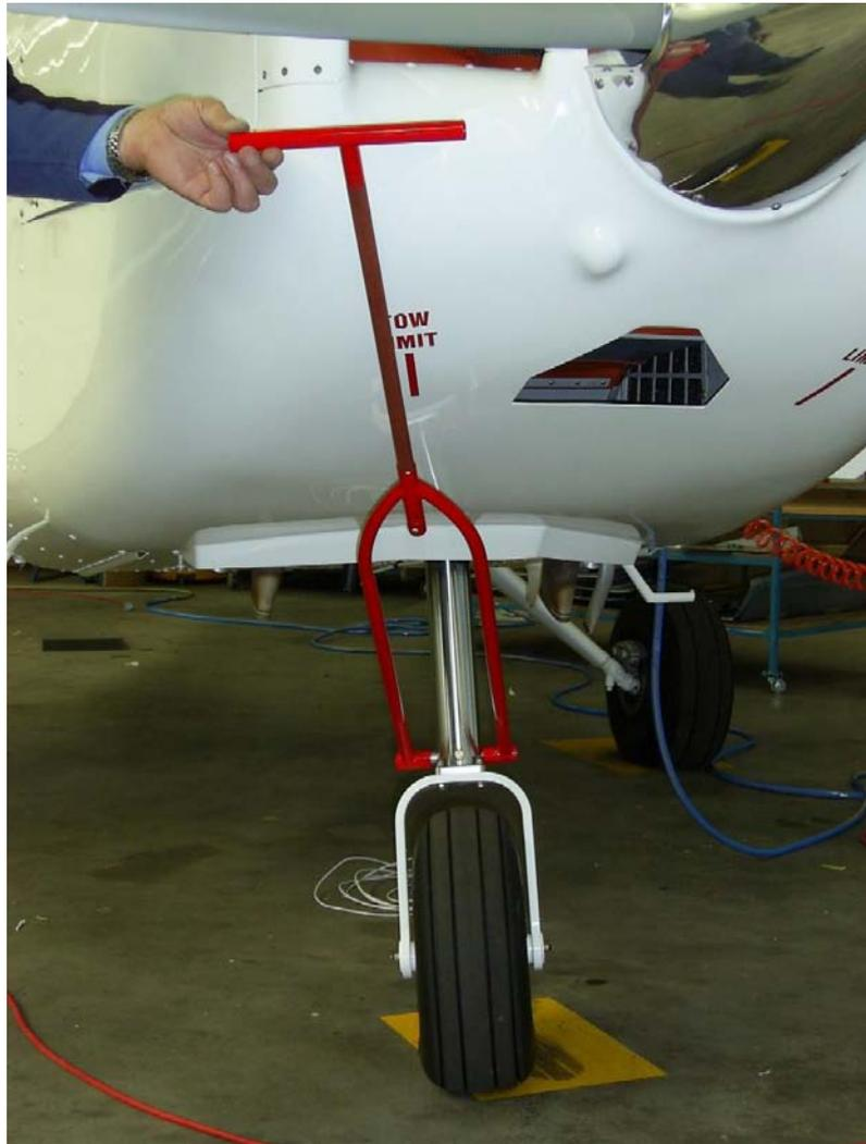
**Figure 1. Marking applied inside the actual limit.**
